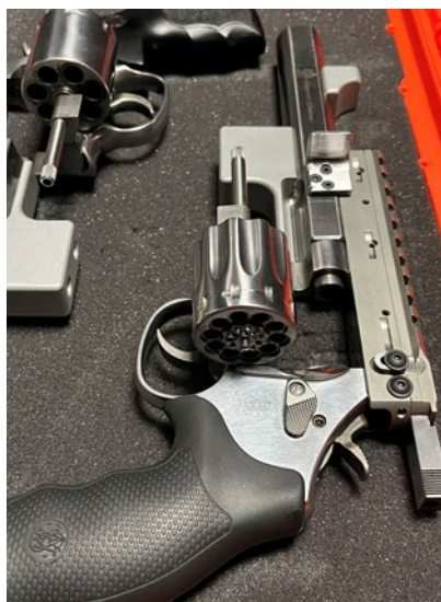
Zwei identische Revolver mit dem Unterschied, .357Mag 7 Schuss und .22LR 10 Schuss.
